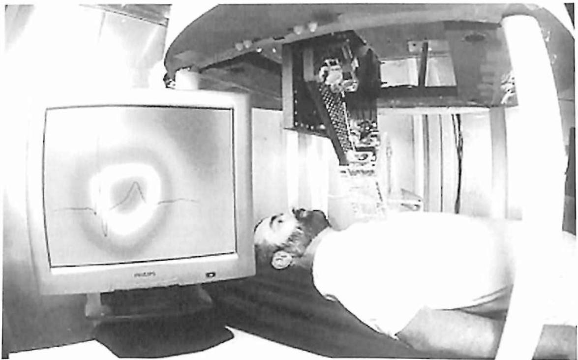
**Fig. 1:** La nouvelle technique de magnétocardiographie dite optique (MCGO) mise au point par le Prof. Weis, combine des méthodes de physique atomique, de spectroscopie laser et de résonance magnétique
