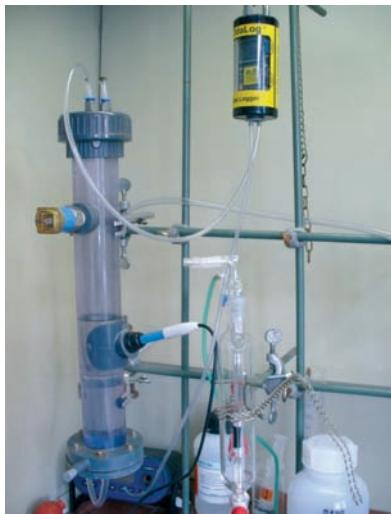
**Abbildung 2:** Versuchsaufbau (Rektor, H<sub>2</sub>S-Messgerät) zur Bestimmung des Zusammenhangs zwischen H<sub>2</sub>S-Konzentrationsverlauf in der ausgestrippten Gasphase und der Sulfidkonzentration in der flüssigen Phase.
